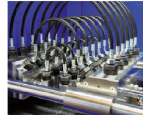
Druck-Impulsprüfung und Hydrostatische Prüfung nach allen gängigen Normen inklusive wechselnde Biegung und Halb-Omega-Prüfung. Durch frei programmierbare Druckkurven und Achsbewegungen sind auch über die Normen hinausgehende Prüfungen möglich.
