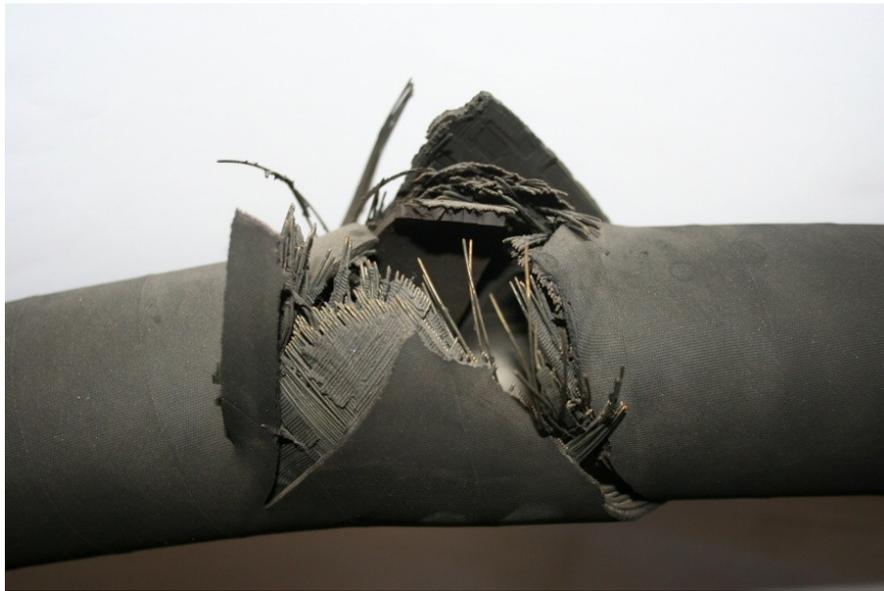
Das Bild zeigt eine Schlauchleitung DN 51 nach DIN EN 856 ISO 1307 Typ R13, Betriebsdruck 345 bar, Berstdruck nach Norm DIN EN ISO 1402 1380 bar, geborsten bei 1462 bar. Die Schlauchleitung hat die Prüfung nach dem Knall um 82 bar übertroffen.
